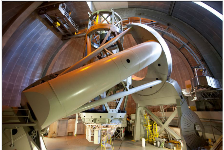
Abb. 4: Das Hale Teleskop hat eine äquatoriale Montierung. Das Fernrohr hängt hier senkrecht mit seiner waagerechten Deklinationsachse im gabelförmigen Teil der Stundenachse. Diese verläuft parallel zur Erdachse und ist rechts unter dem „Hufeisen“ und links unten gelagert. Das Fernrohr wird so um die Stundenachse dem am Himmel zu beobachtenden Objekt nachgedreht.
