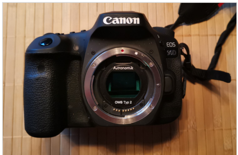
Abb. 5: Kamera Canon 90Da mit eingesetztem Weißabgleich-Clipfilter OWB Typ 2 von Astronomik
