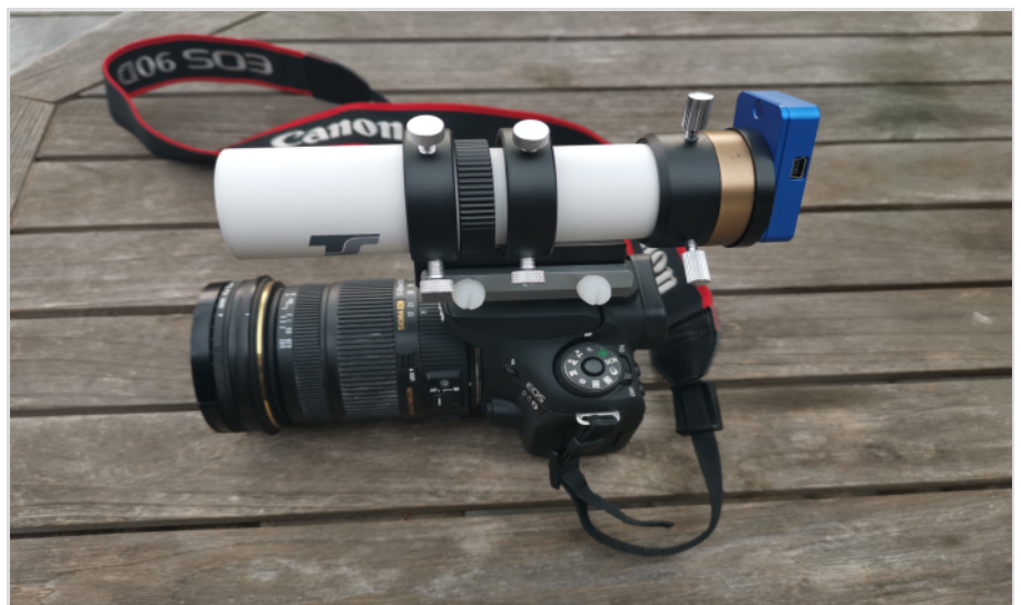
Abb. 7: Mini-Leitrohr mit Sucherhalter für Blitzschuh an der Canon 90Da.
