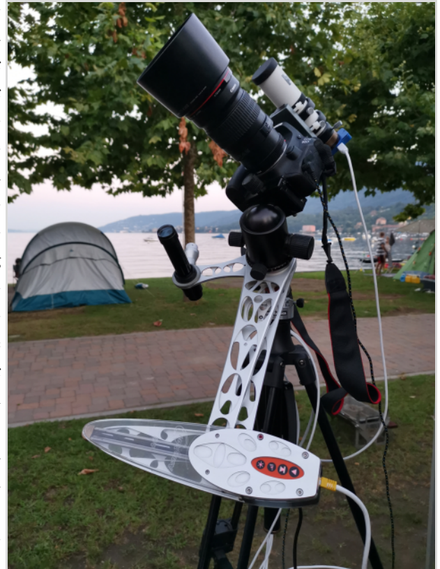
Abb. 2: Reisemontierung AstroTrac mit ST4-Anschluss, Polsucher und astromodifizierter Kamera.
