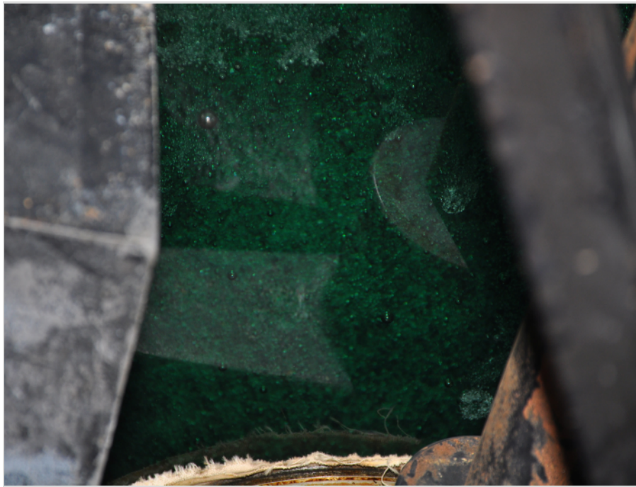
Abb. 9: Die Blasen im Glas des 100“ Spiegels. Zu sehen durch einen Einlass von oben ist der aus grünem Glas gegossene Spiegel.
