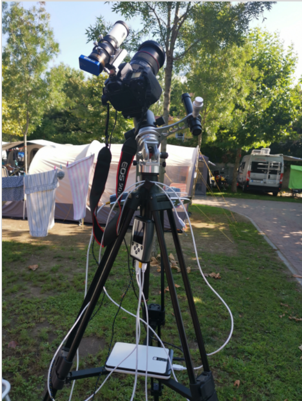
Abb. 4: AstroTrac mit Canon 90Da, Mini-Leitrohr, Polsucher, M-GEN V3 und Powerbank.
