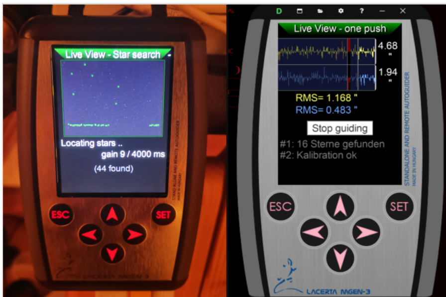
Abb. 3: Handsteuerbox der M-GEN V3 in realer und virtueller Darstellung.
