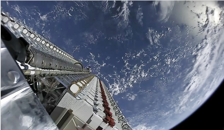
Abb. 5: Zwei Stapel mit insgesamt 60 Starlink-Satelliten auf einer Falcon-9-Oberstufe. Bild: Starlink Mission / Official SpaceX Photos
