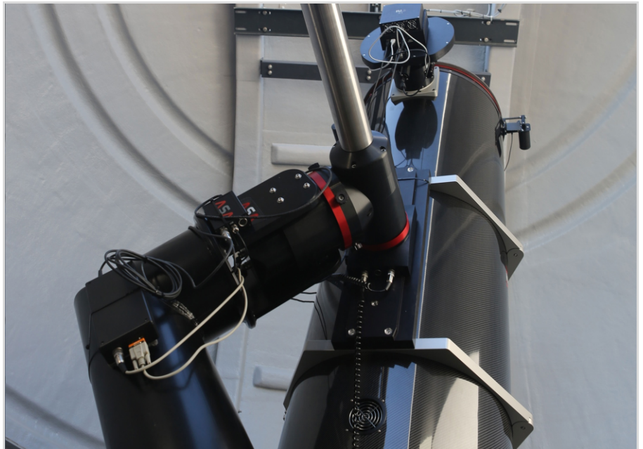
Abb. 8: SA 500N, 50 cm F3.8 korrigiertes Newton-Teleskop am Standort Rio Hurtado Valley in Chile [24].
