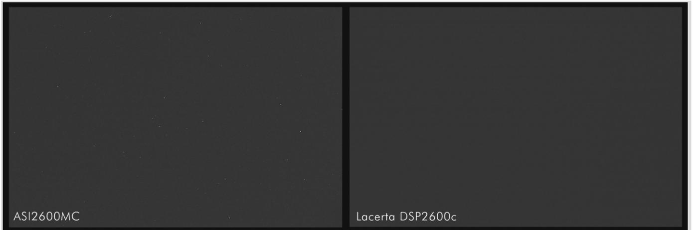
Abb. 10: Vergleich von zwei Dark-Frames bei Gain 100 und 5 min Belichtung, -10 Grad Celsius.
