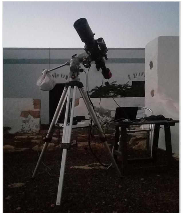
Abb. 2: Die Vixen GP Montierung mit Teleskop auf dem Alustativ.
