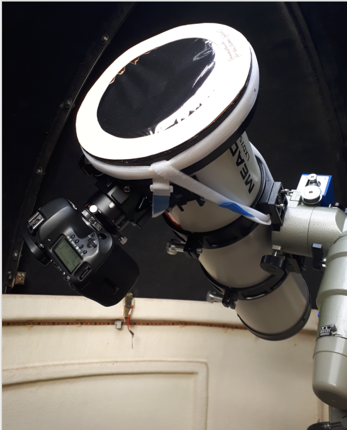
Abb. 4: Das Meade LX200 mit zusätzlich gesicherter Sonnenblende auf der Vixen GPDX Montierung in der kleinen Sternwarte.
