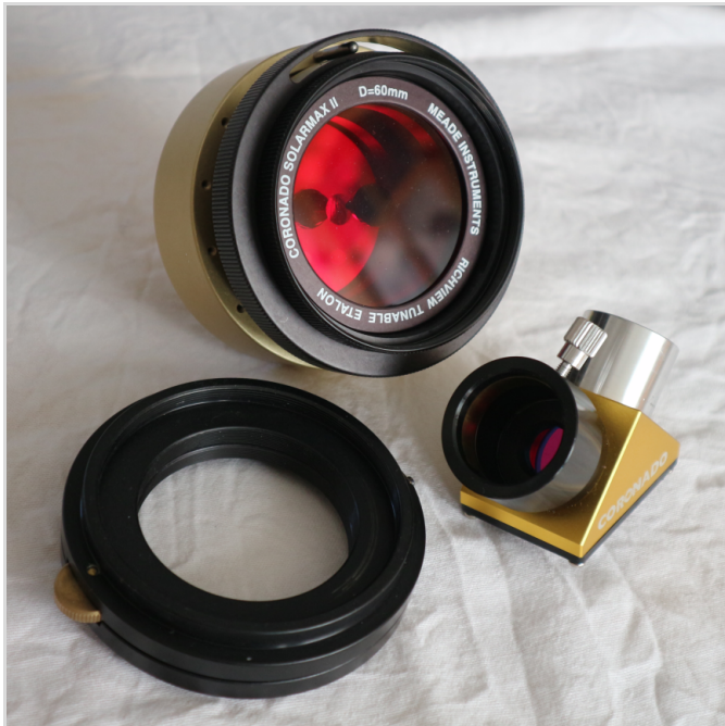
Abb. 3: H \alpha -Filtersystem „SolarMax II D=60“ besteht aus: Oben, D60: Schmalband Element mit Energy Rejection Filter (ERF) „Etalon“ (gold) und „RichView tuning ring“ (schwarz). Links: „T-max tuner“ (schwarzer Ring) mit „Tilt wheel“ (Messing). Rechts, BF15: 1/4“ Zenitspiegel mit 2 eingebauten Blockfiltern 15mm.
