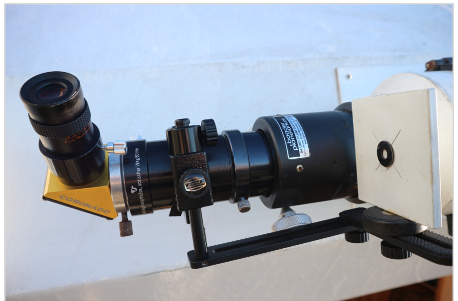
Abb. 7: Der an einer 2“ Verlängerungshülse befestigte Sonnenprojektionsschirm ist nach dem Ausrichten des 6“-Refraktors zur Sonne zurückgeschwenkt. In die im 2“ Okularauszug steckende Verlängerungshülse ist über die Reduzierhülse (Alu) das 1¼“ BF15 mit einem 1¼“ Okular 19mm gesteckt. Mit dieser Kombination und dem D60 vor dem Objektiv ist die Sonne in 39-facher Vergrößerung bildfüllend dunkelrot sichtbar.
