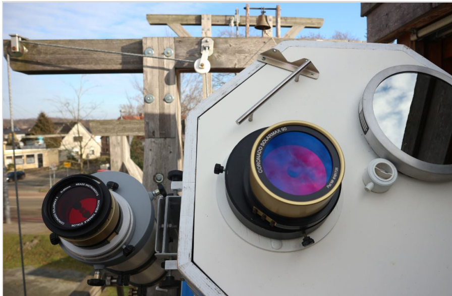
Abb. 6: Links: Coronado Solarmax II D60 (schwarz/gold), „T-max-tuner“ (schwarz) verschraubt mit 4“ Adapterring (Alu) und 6“ Verbindungsadapter (grau) auf 6“-Refraktor. Mitte: Solarmax 90 (gold) mit „T-max-tuner“ (schwarz), verschraubt mit 6“ Off-Axis-Adapter (schwarz). Rechts: Glas-Sonnenfilter 8“ für Weißlicht-Beobachtung. Beide montiert auf der Sonnenfilterplatte des 20“ Spiegelteleskops.
