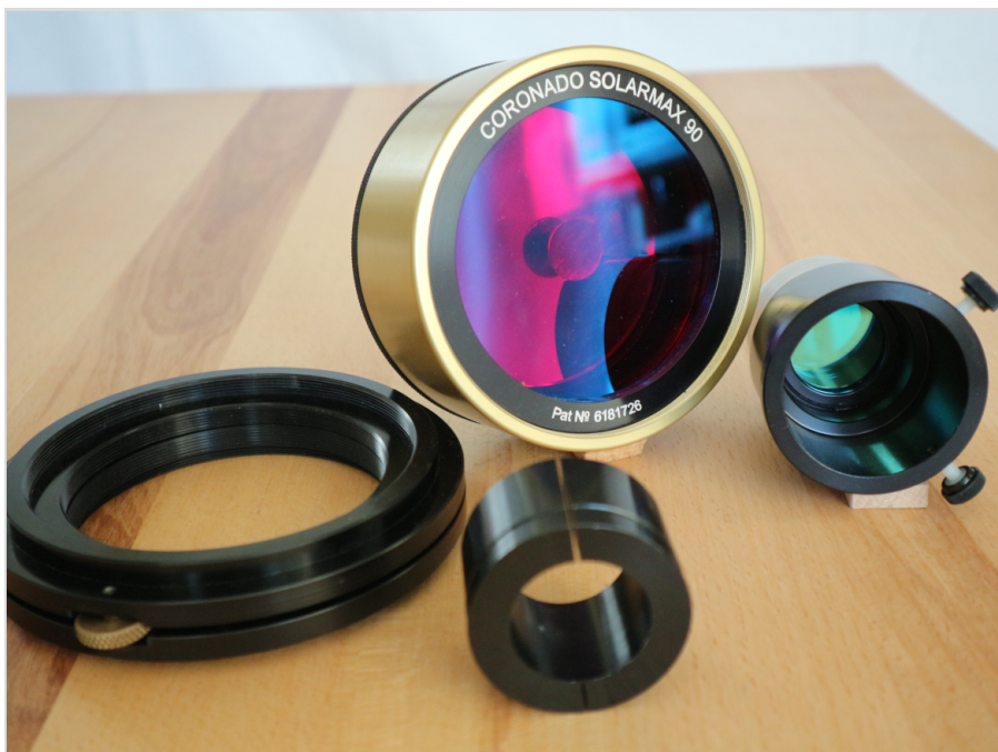
Abb. 1: H \alpha -Filtersystem SolarMax 90 besteht aus: Oben, D90: Schmalband Element mit Energy Reduction Filter (ERF) „Etalon“ (gold). Links: „T-max tuner“ (schwarzer Ring) mit „Tilt wheel“ (Messing). Rechts, BF30: 2“ Verlängerungshülse: mit 2 fest eingebauten Blockfiltern 30mm, Vorne: 2“ Reduzierhülse für Okulare mit 1/4“ Steckhülse.
