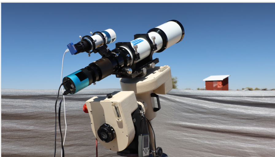
Abb. 7: Fornax 51-Montierung mit aufgesatteltem Refraktor APM APO 107/700 mm.
