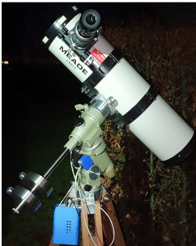
Abb. 10: Die umgebaute SPM mit der OnStep Steuerung und einem aufgesetztem Newton.
