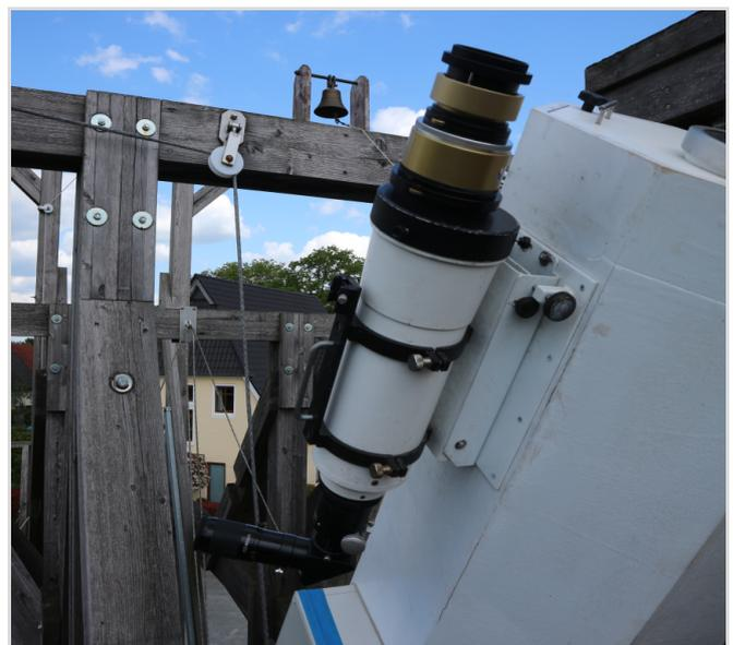
**Abb. 5:** Die Filtereinheit mit 6“ Fernrohradapter auf dem Objektiv-Tubus des 6“ Refraktors. Die beiden Tilt wheels liegen parallel zueinander. Das bedeutet die Neigung der beiden Filterachsen können nur in die gleiche Richtung verstellt werden. Im Hintergrund das Hotel „Borgfelder Landhaus“.
