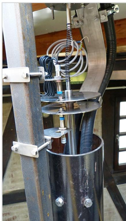
Abb. 5: Sensorik für den Azimutwinkel des gesamten Teleskop.
