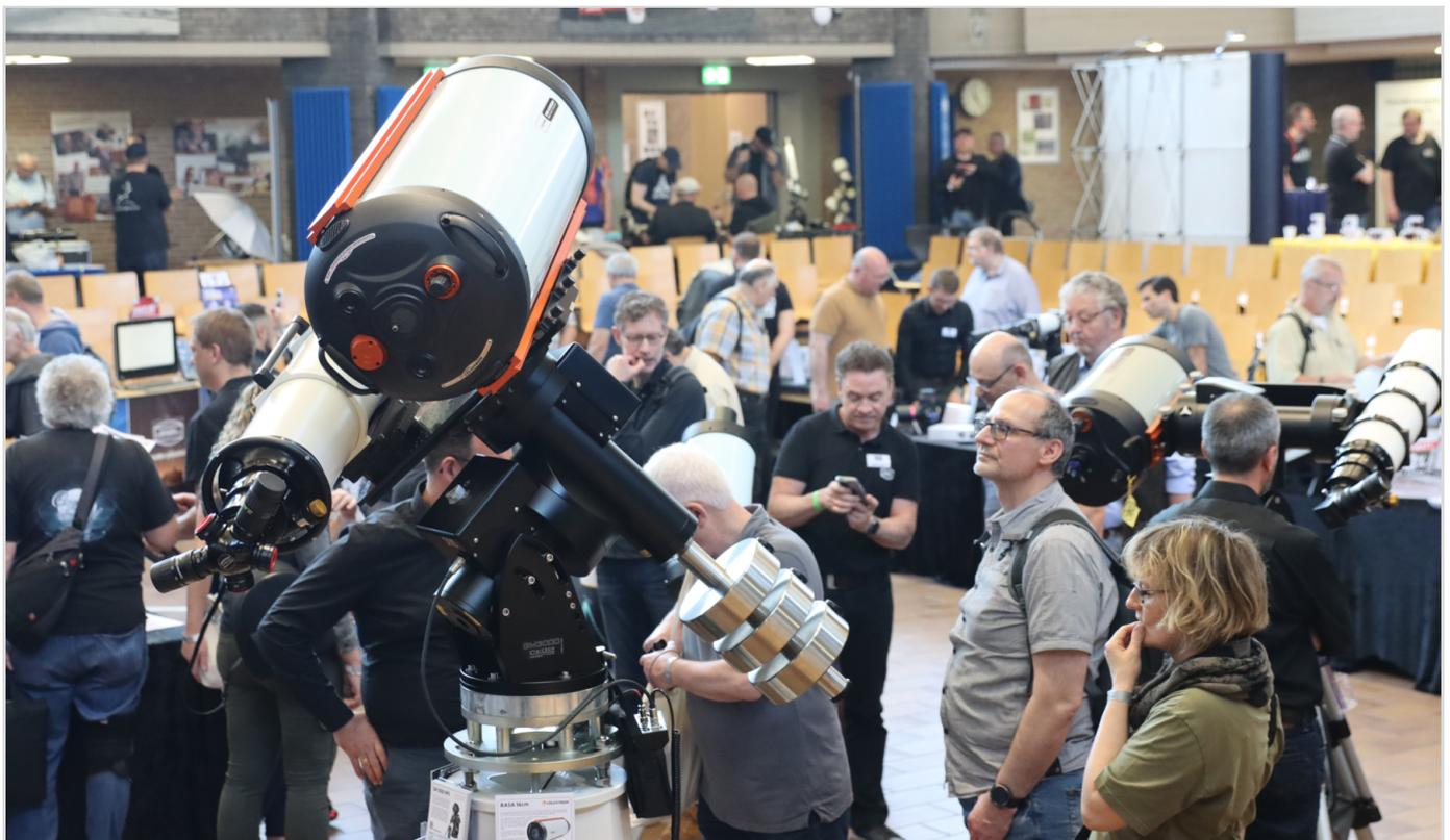
Abb. 5: 10Micron GM3000-Montierung mit Refraktor und RASA-Teleskop im Parallelbetrieb.
