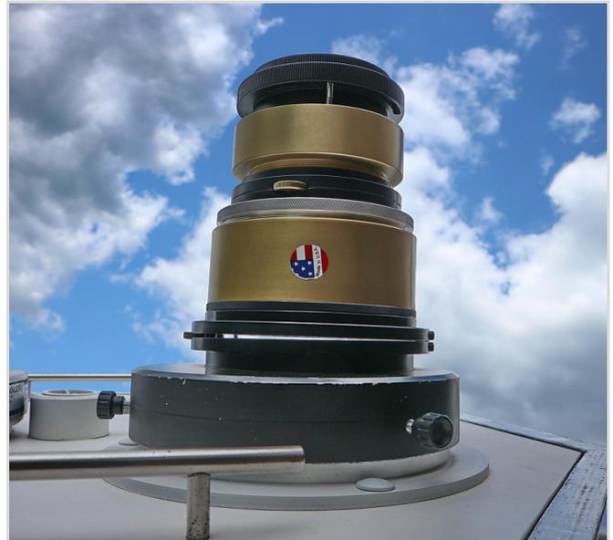
**Abb. 6:** Die Filtereinheit mit 6" Fernrohradapter auf der Sonnenfilterplatte des 20" Spiegelteleskopes. Deutlich ist der keilförmige Spalt des D90 T-max tuners zu sehen. Die Achse des ERF Etalon D90 ist gegenüber der Fernrohrachse geneigt. Das Tilt wheel des D60 ist 90° dazu verdreht, sodass seine Achse in eine andere Richtung geneigt werden kann.
