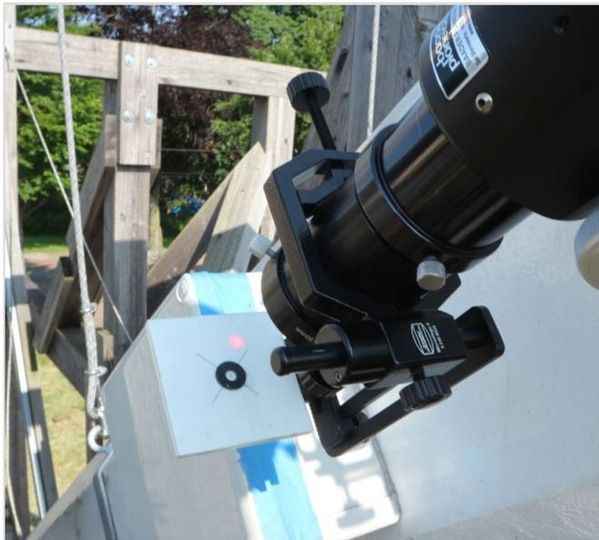
**Abb. 4:** Die Sonne kann auch mit einem aufgesetzten ERF (Abb. 3) projiziert werden. Mit einem Weißlichtfilter ND5 ist das nicht möglich, weil damit die Sonne zu dunkel ist. Beim Gebrauch der Einheit mit 1¼“ Steckhülse für Okulare 19 mm und 10 mm wird der Schirm nach unten geklappt.
