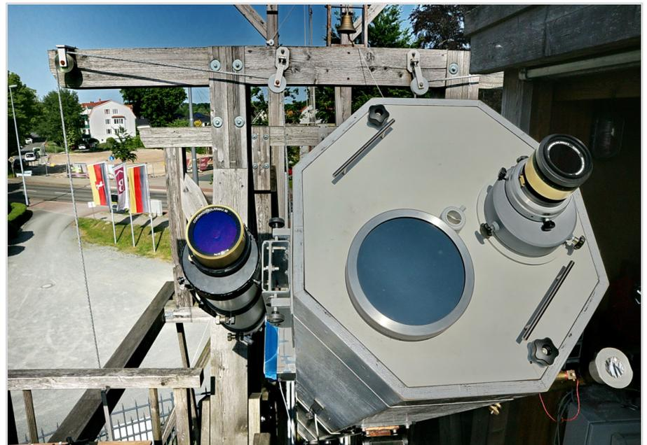
Abb. 3: Links: ERF D90 auf dem Refraktor. Rechts: ERF D60 auf dem Reflektor. Da beide Filter 6" Fernrohradapter haben, sind sie austauschbar. Mitte: 8" Weißlichtfilter. Im Hintergrund unsichtbar das abgerissene Lokal „Borgfelder Landhaus“.
