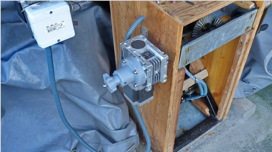
Abb. 6: Schnapp-Mechanik der Getriebe-Kupplung.
