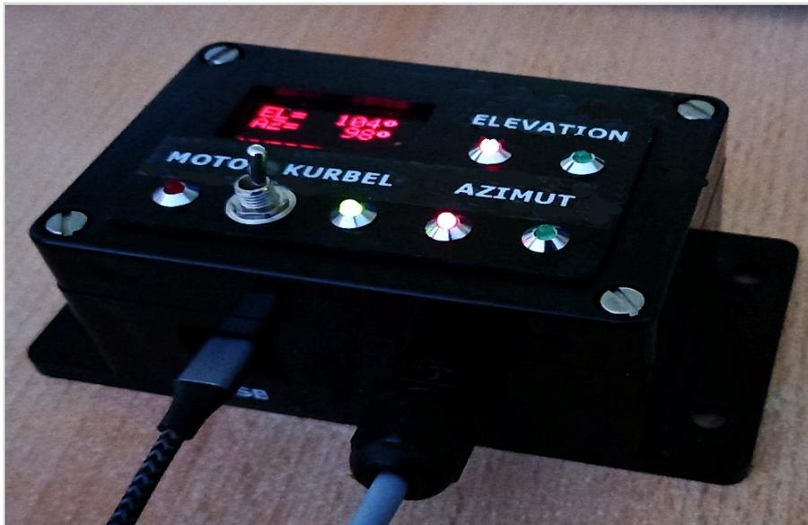
Abb. 20: Umschaltung Motor-Handbetrieb.
