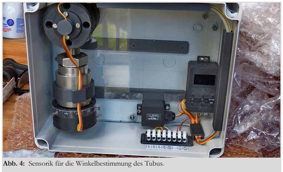
Abb. 4: Sensorik für die Winkelbestimmung des Tubus.
