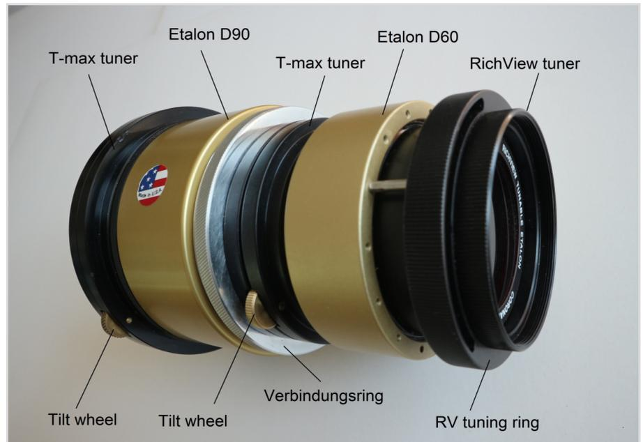
Abb. 2: Zwei H $\alpha$  ERF Etalon „Coronado SolarMax“ D90 und D60 mit Verbindungsring (Aluminium) zusammengesraubt (double stacked) zu einer Schmalband Filtereinheit 0,5 Å.
