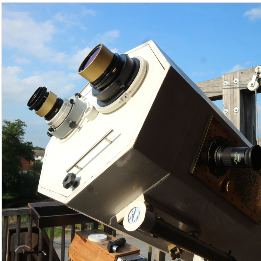
Abb. 4: Zwei H \alpha -ERF Etalon „Coronado SolarMax“, D60 (Links) und D90 (rechts) mit ihren beiden Adaptern „Off-Axis“ parallel auf der Sonnenfilterplatte des 20“ Newton-Spiegelteleskopes. Mit Okular 60 mm folgt 132-fache Vergrößerung (7920/60).
