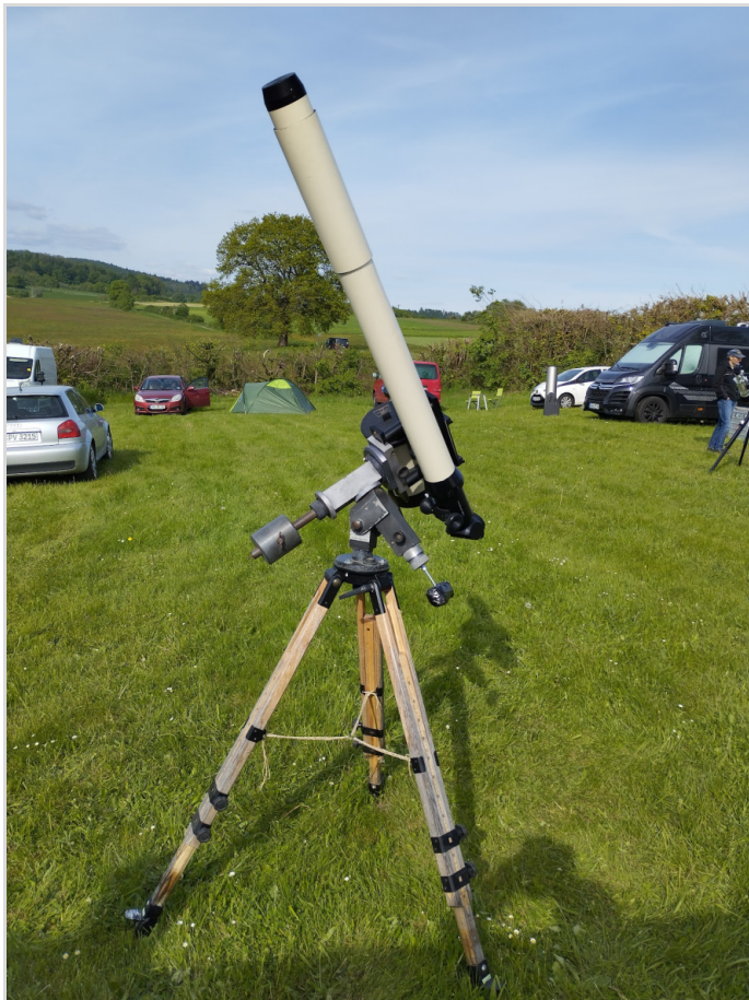
Abb. 5: Ein Lichtenknecker/ Kutter Schiefspiegler 110 mm / 2720 mm Brennweite f/25 .
