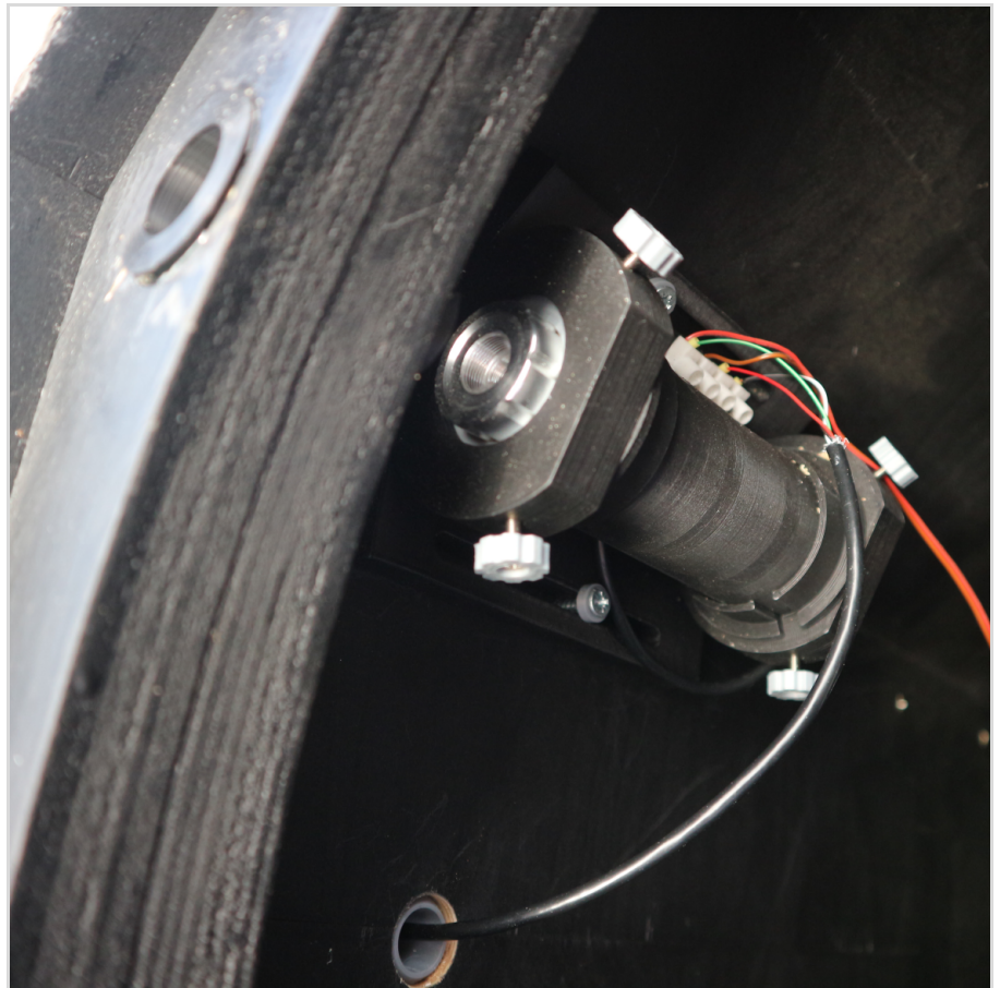
Abb. 2: Blau leuchtender (450 nm) Laser, mit dem Himmelsobjekte bei Nachtbeobachtungen mit dem Spiegelteleskop direkt anvisiert werden können.
