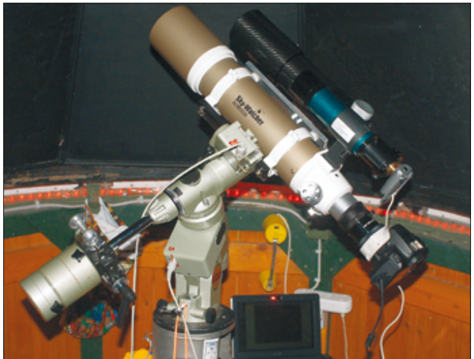
Abb. 3: ED80 mit Kamera, Leitrohr mit Webcam und Laptop mit Guidingprogramm
