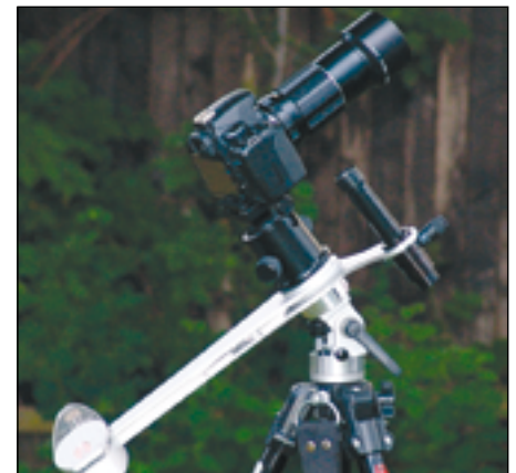
Abb. 5: Astrotrac auf Mini-Polhöhenwiege mit Kamera und zoomm-Objektiv (Foto: E.-J. Stracke)
