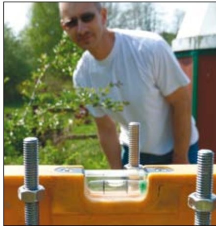
Abb. 6: Prüfung der ausgerichteten Säule.
