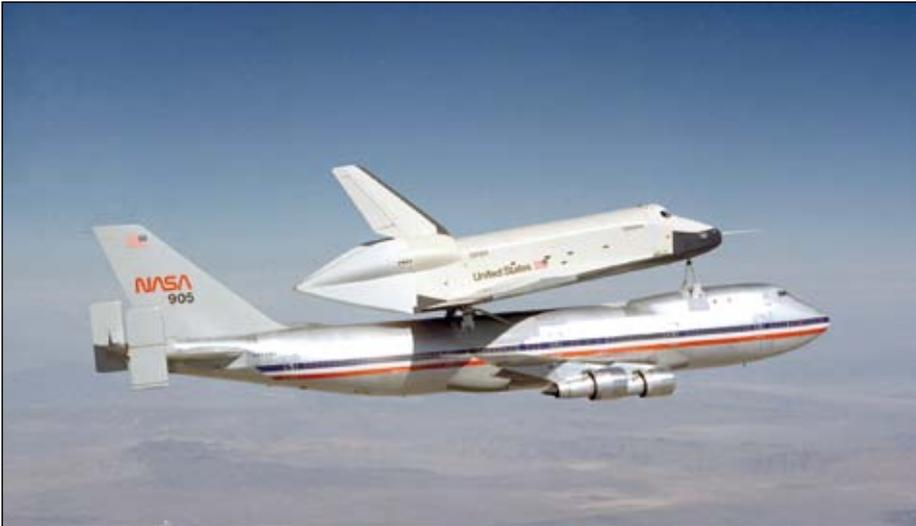
**Abb. 2: Huckepack-Transport eines Space Shuttles [2]**
