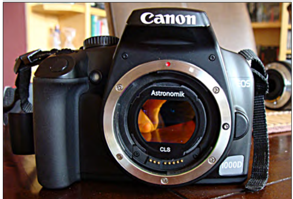
Abb 5.: Umgebaute DSLR-Kamera 1000D mit Astronomik CLS-Filter
