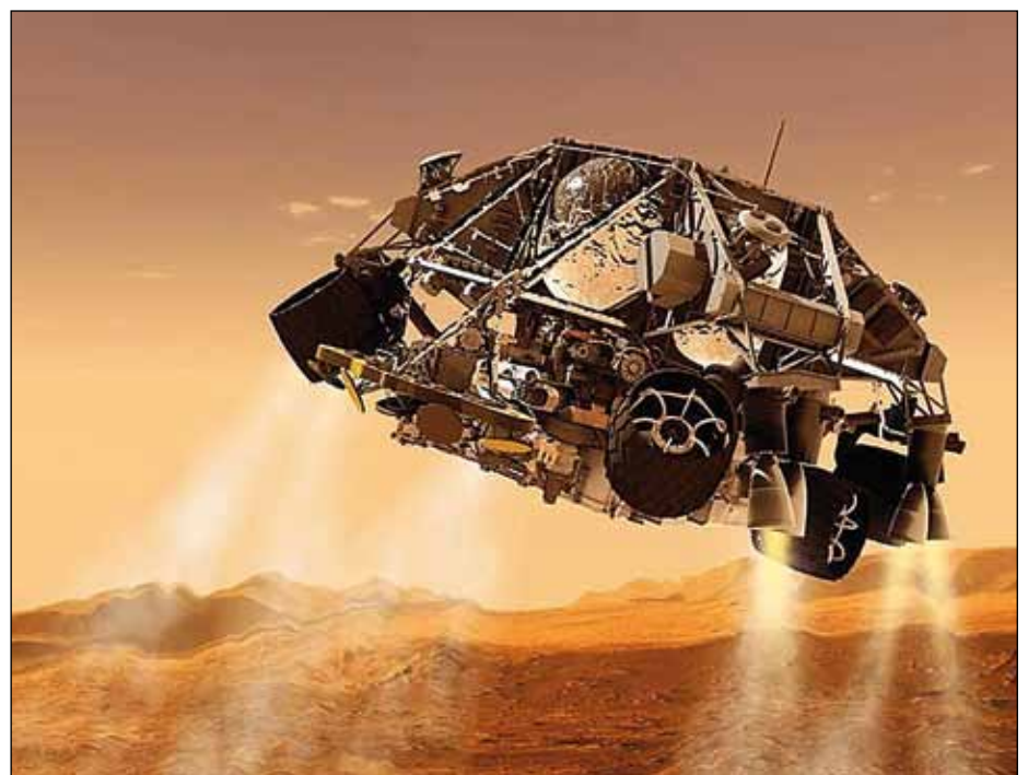
Abb. 1: Der Sky Crane mit seinen acht Bremsraketen in Aktion [2]
