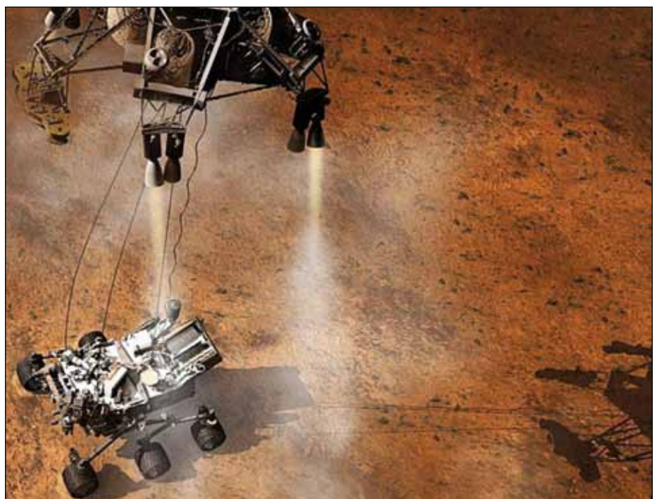
Abb. 2: Sanftes Ablassen der Curiosity auf den Marsboden [2]
