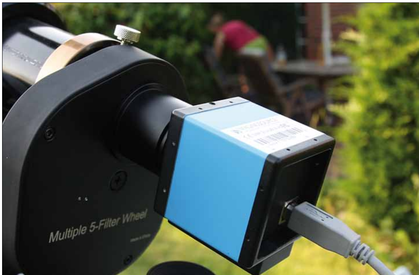
Abb. 3: CCD-Kamera von TIS mit Filterrad am ED70-Refraktor.
