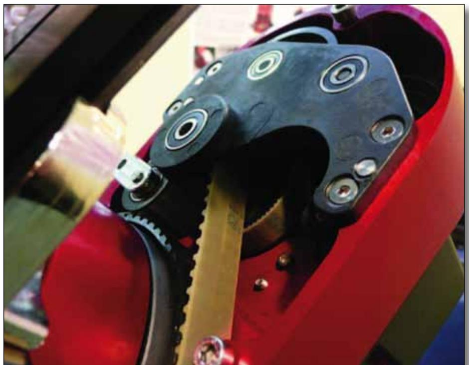
Abb. 7: Zahnriemenantrieb der Avalon-Montierungen [9].
