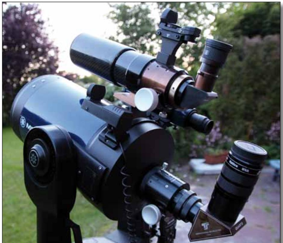
Abb. 1: SC-Teleskop mit azimutaler Gabelmontierung und aufgesatteltem ED70-Refraktor.
