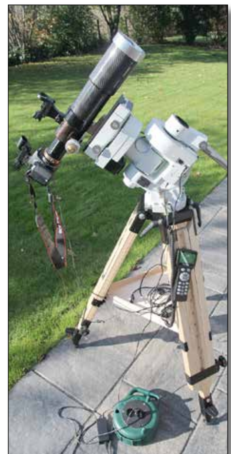
Abb. 3: ED70-Refraktor mit DSLR-Kamera Canon 1000D(a) auf iOptron CEM60.
