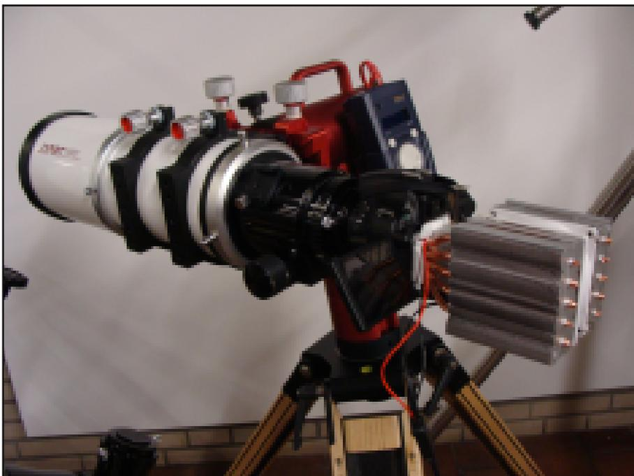
Abb. 5: Kühlung für DSLR-Kameras ohne Umbaumaßnahmen.
