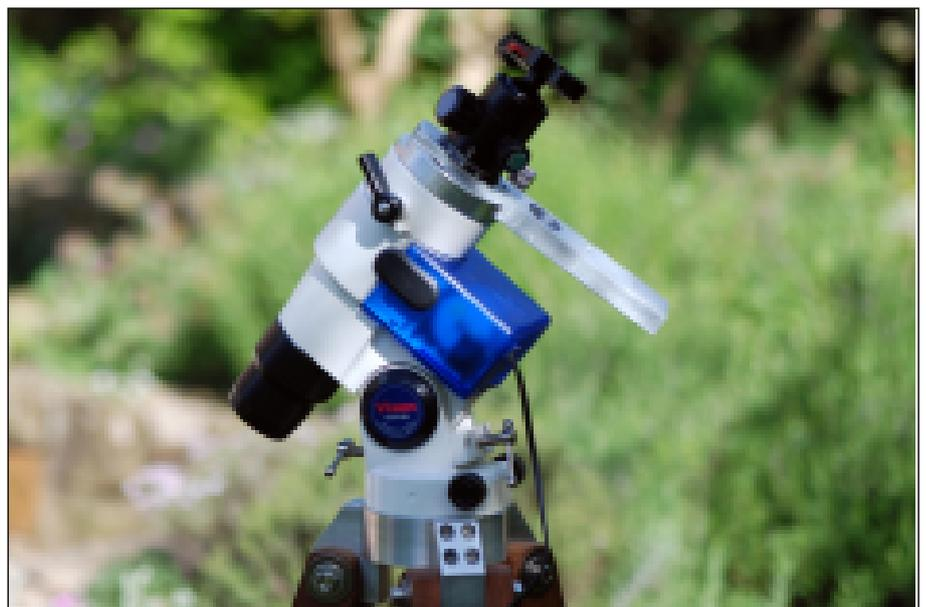
**Abb. 2:** Der „Photoguiden“ des Autors bestehend aus dem RA-Teil einer Vixen GP-2 und einer darauf montierten selbstgefertigten Prismenklemme für eine Prismenschiene, auf der ein stabiler Kugelkopf montiert wurde.
