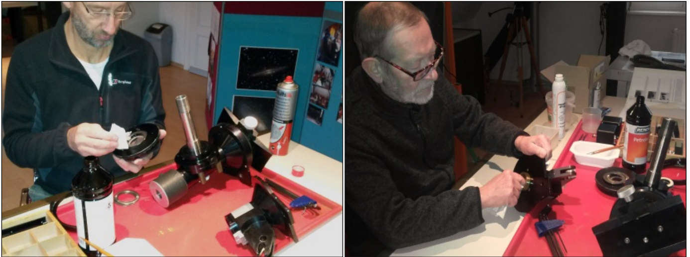
Abb. 3 & 4: Verharztes Fett entfernen, Lager reinigen.
