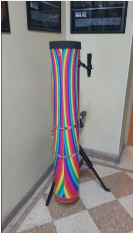
Abb. 3: Ein selbstgebauter Newton mit selbstgeschliffenem Spiegel.
