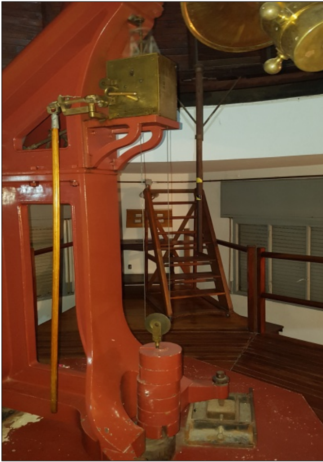
Abb. 5: Mechanische Nachführung am Gautier-Teleskop.
