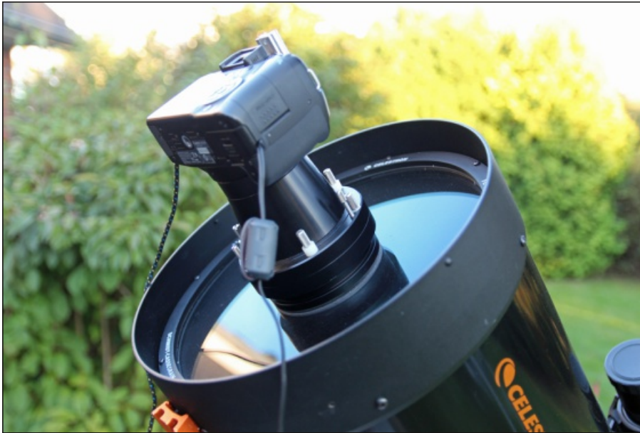
Abb. 2: HyperStar mit DSLR-Kamera am C11-Teleskop, anstelle eines Fangspiegels.
