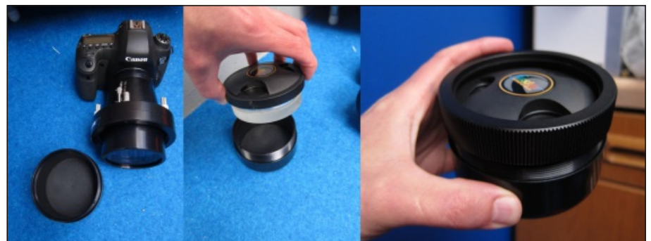
Abb. 4: HyperStar an der DSLR-Kamera und Schutz des Fangspiegels [3].
