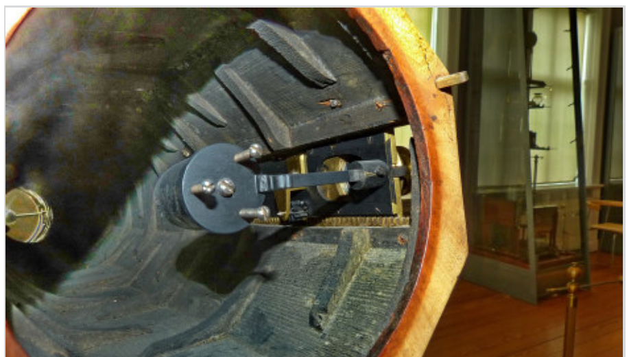
Abb. 3: Blick in den Tubus, Fangspiegel, Hauptspiegel am anderen Ende.
