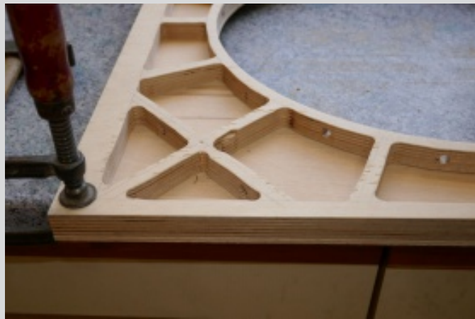
Abb. 12: Das Innere des Bodenbretts der Rockerbox.
