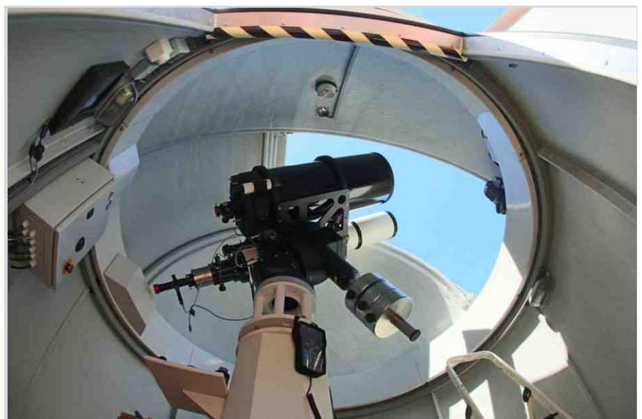
Abb. 7: ATHOS-Sternwarte mit der GM3000-Montierung und den beiden großen Teleskopen.
