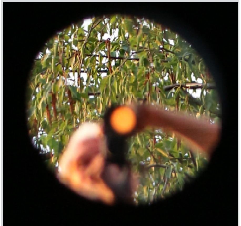
Abb. 4: Der Blick ohne Okular von vorne durch die Öffnung direkt auf den Spiegel. Er zeigt mit seiner Eigenvergrößerung Laub und Früchte der etwa 25 Meter entfernten Birke. Da der Fotograf im Vordergrund sich selbst im Weg steht ist er unscharf. Der gelbe Fleck ist die im Umlenkspiegel sichtbare Bretterwand der Kabine durch die seitliche Okularfassung.
