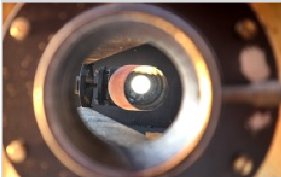
Abb. 3: Blick durch die seitliche Okularfassung mit Durchmesser 2 Zoll, ohne Okular. Rechts im Vordergrund sehr unscharf die Klemmschraube. Scharf abgebildet ist der Umlenkspiegel in seiner Halterung. Die weiße Scheibe im Hintergrund ist die Öffnung des Spiegelteleskops.
