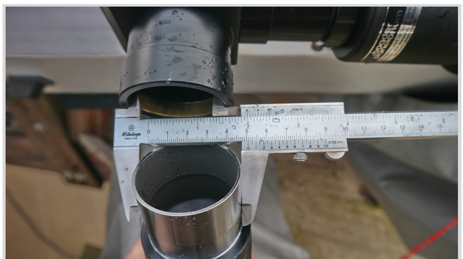
Abb. 4: Okular mit 2 Zoll Stekhülse vor einer 2 Zoll Okularfassung eines Zenitspiegels am Okularauszug des Refraktors. Das Okular passt auch in die Okularfassung des Okulartriebes am Reflektor (Abb. 3, Seite 31, Hipo 59). Auf der Schieblehre werden auf der oberen Skala 2 Inches gemessen auf der unteren Skala 50,8 Millimeter.
