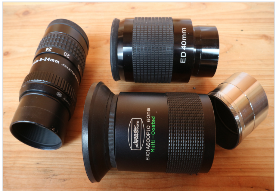
Abb. 2: Links: Zoom Okular mit Brennweite 8 bis 24 mm. Rechts: Okulare mit Brennweite 40 mm und 60 mm. Hier ist die 2 Zoll-Steckhülse abgeschraubt um es als Lupe zu verwenden.
