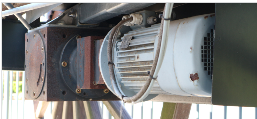
Abb. 1: Elektromotor (grau), der über das Getriebe (links davon, schwarz) und einer Kette das Rad antreibt, zum Verfahren der Beobachterplattform (Grobe Azimutal-Verstellung). Alle Abbildungen vom Autor.
