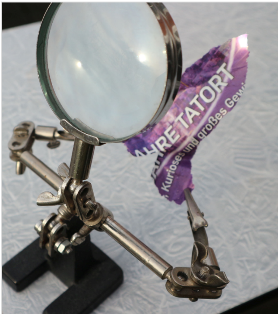
Abb. 2: Alle Frequenzen (Farben) im Spektrum des sichtbaren Bereiches der elektromagnetischen Wellen werden mit einer Sammellinse im Brennpunkt vereinigt. Steht sie in der Sonne, entsteht am Objekt sehr schnell große Hitze. Deshalb sollten optische Geräte im Haus immer verhüllt sein.
