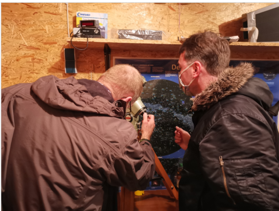
Abb. 11: Untersuchung des Polsuchers an einer Vixen GP-DX-Montierung [13].
