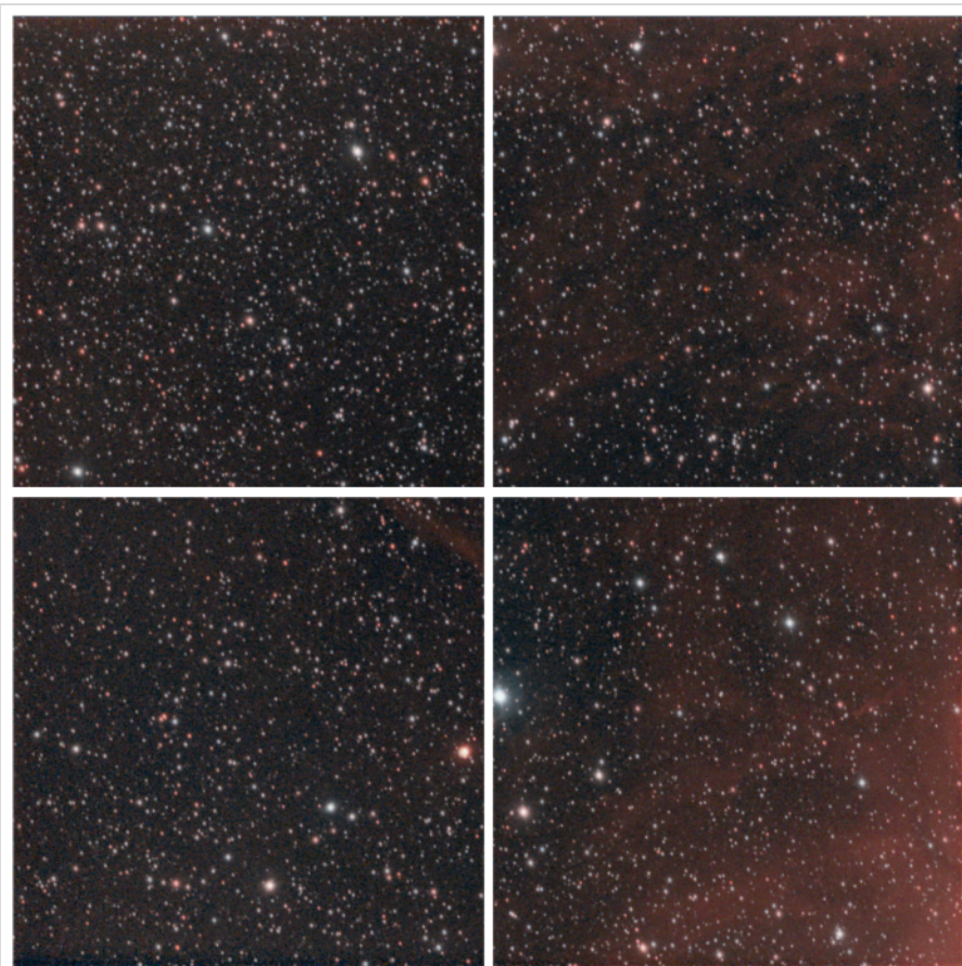
Abb. 10: Alle Eckenbereiche der Testaufnahme mit optimaler Sternabbildung.
