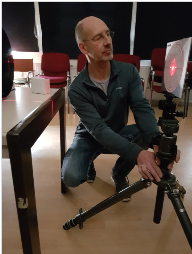
Abb. 14: Ausrichtung des Hotech-Kollimators mittels Justierlaser und stabilem Fotostativ [8].
