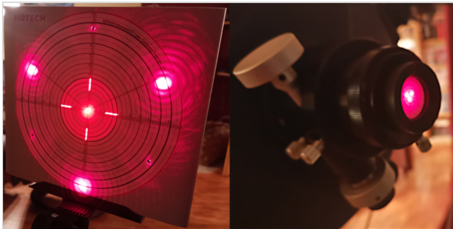
Abb. 11: Reflektierte Laser auf dem Kollimator und die drei Laser am Okularauszug auf der Zentrierscheibe.
