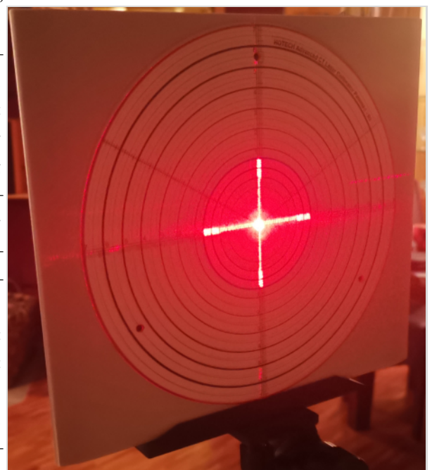
Abb. 8: Optimales Kollimationsergebnis am HyperStar-System.
