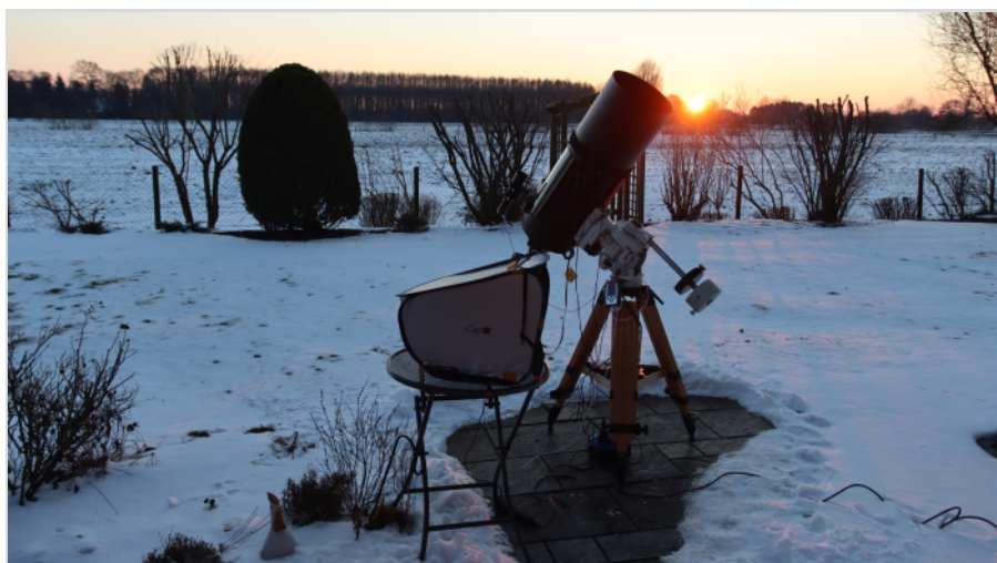
Abb. 1: C11-Teleskop mit HyperStar-Korrektor und Taukappe für Aufnahmesession im Winter vorbereitet.
