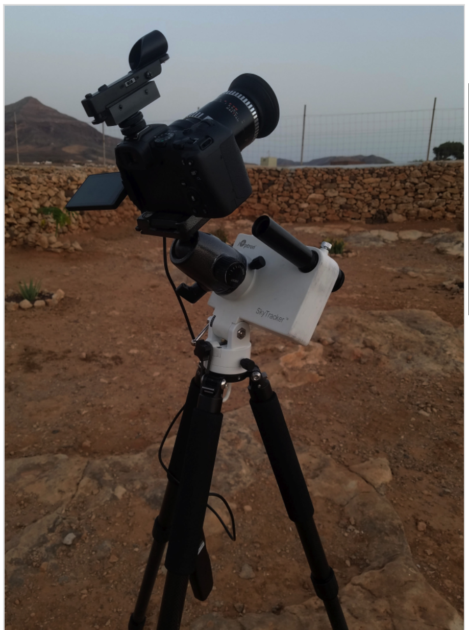
Abb. 1: Astrofotografie unterwegs mit leichtem Equipment. Die Canon EOS RP(a) auf dem Skytracker von IOptron. Gesamtgewicht mit Stativ, Kugelkopf, Timer, 135mm-Objektiv und Leuchtpunktsucher: 4,1 kg.
