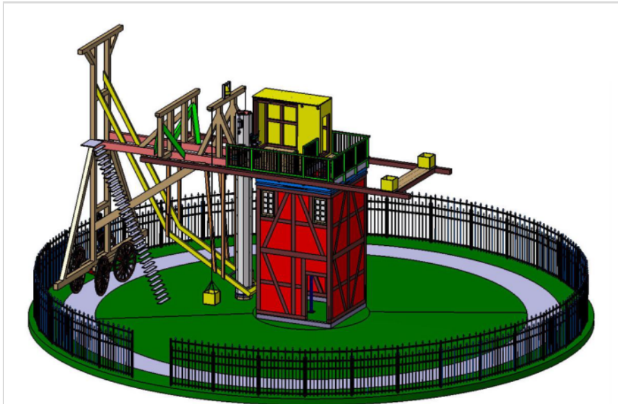
Abb. 2: Teleskop, Baujahr 2015, Spiegeldurchmesser 51cm (20 in), Brennweite 7,90 m (27 Fuß) Die Maße gelten für die Rekonstruktion, die hier in einem CAD-Modell gezeigt ist.
