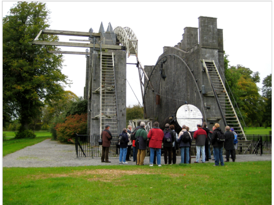
Abb. 4: Teleskop, Baujahr 1845, Spiegeldurchmesser 183 cm (72 in), Brennweite 16,50 m (54 ft) War bis 1917 das größte der Welt.
